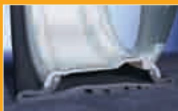
Συμβατικά ελαστικά όταν χαθεί όλη η πίεση: το ελαστικό καταστρέφεται σε μικρή απόσταση.
