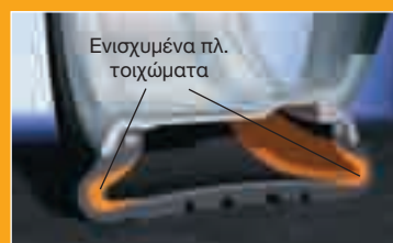
Ελαστικά SSR: επιτρέπουν την κίνηση για μέχρι και 80 km με μέγιστη ταχύτητα 80 km/h.
