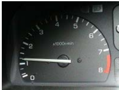
Εικόνα 3.2: Στροφόμετρο ένδειξης στροφών του κινητήρα ανά λεπτό
